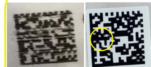
Смазывание кода маркировки или его отдельных элементов
