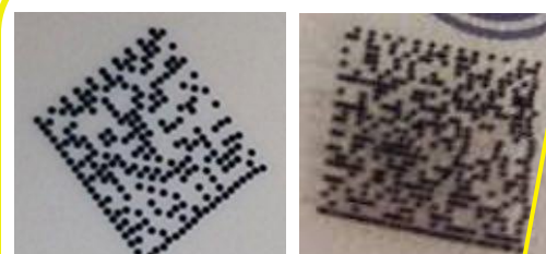
Нарушение геометрии кода маркировки (модуляция)
