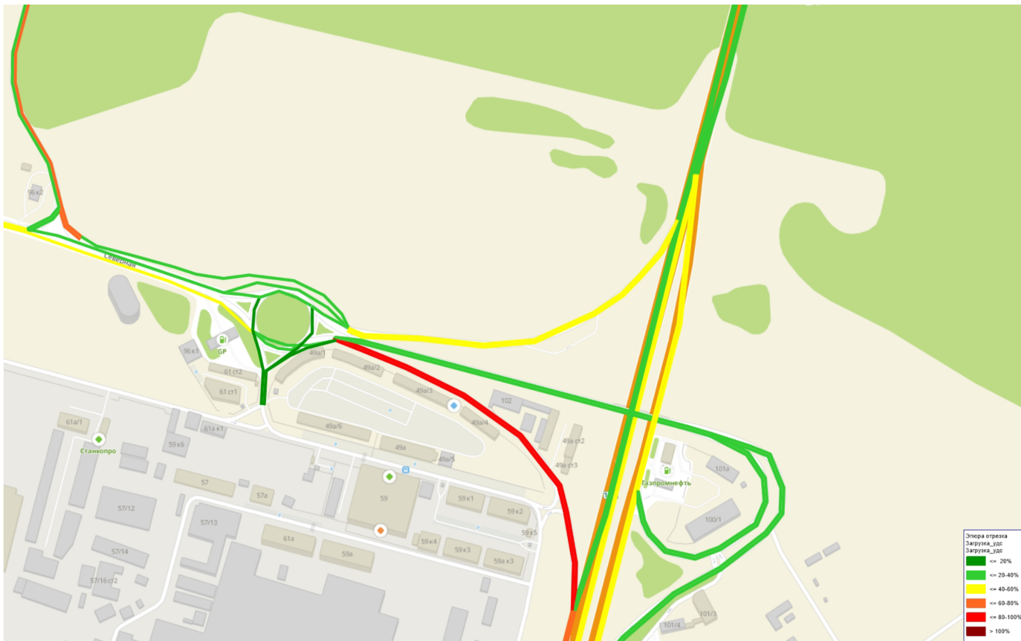
Рисунок 2.2.3 – Картограмма уровня загрузки УДС на «Северном» въезде в город (ул. Северная), проект. положение
